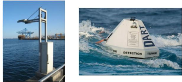
Fig.1. Izquierda: mareógrafo de Puertos del Estado en el puerto de Las Palmas. Derecha: boya DART conectada a un sensor de presión en el fondo marino (NOAA <http://nctr.pmel.noaa.gov/Dart/>.)
